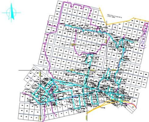
*Ilustración 11: Diseño de red de agua potable (impulsión y distribución) para 600 lotes en Laguna Verde*
