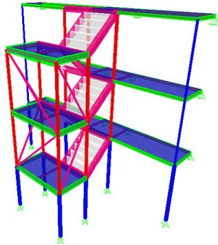
*Ilustración 7: Modelo Sap2000 de escalera metálica*
